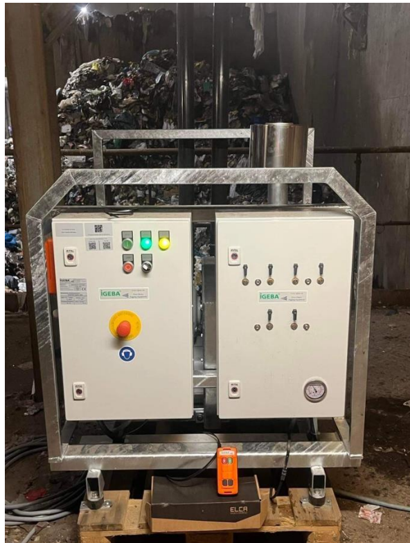
Groupe de pulvérisation équipé de 6 têtes à fort pouvoir directionnel
